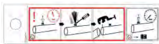
940 - Wskazówka ostrzegawcza - „Wypełnienie na czas transportu” przy zaworze Schradera
